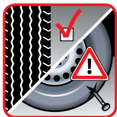
Vérifiez le profil des pneus et assurez-vous qu'ils ne sont pas endommagés (trous...)
